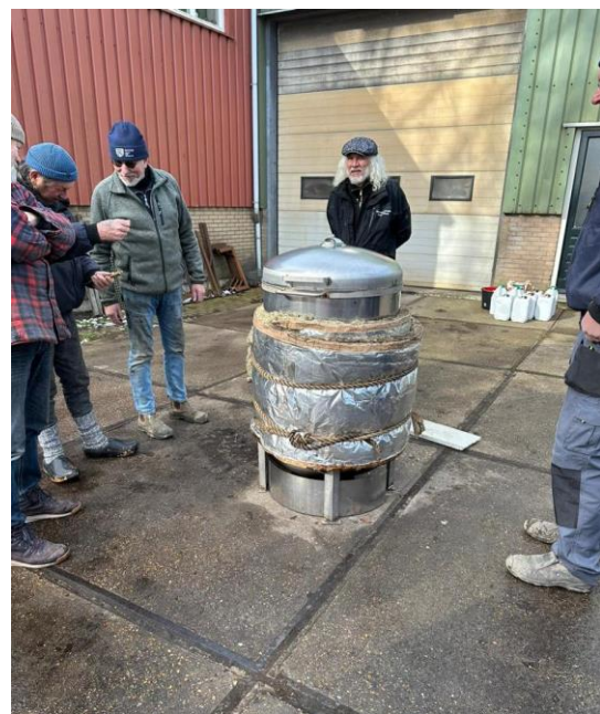
De nieuwe roestvrijstalen taanketel wordt gebruikt en bewonderd. Er is glaswol ter isolatie omheen gewikkeld. Onder de ketel brand een gasvlam.
