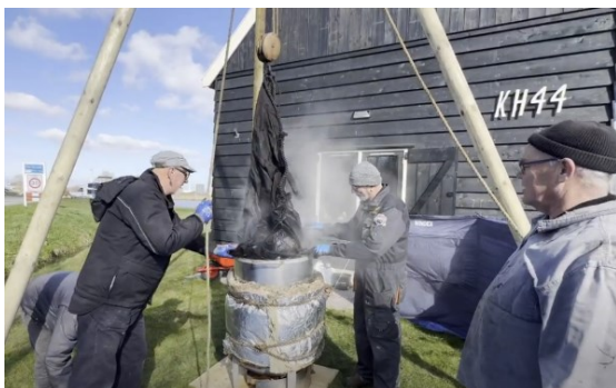
Het grootzeil komt dampend uit de taanketel.
